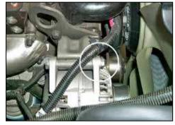
18. Remove the upper alternator bolt.
